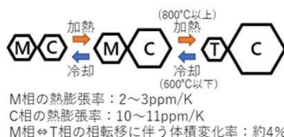
図3 部分安定化ジルコニア固体電解質における結晶構造変化の例
